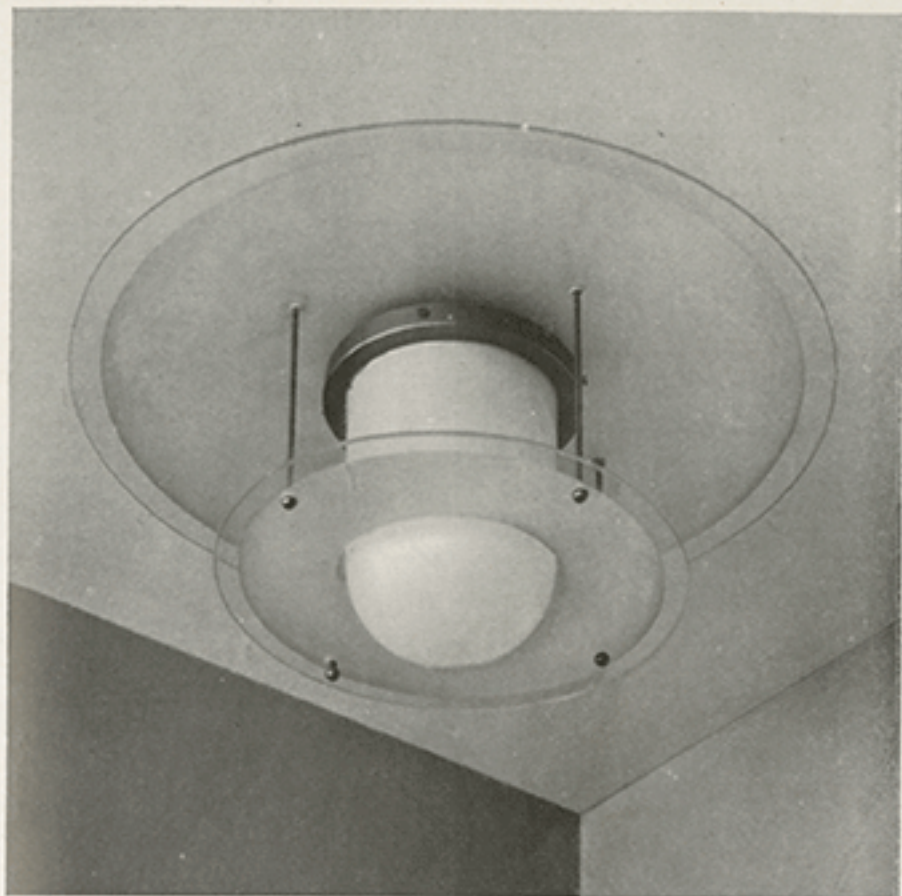
GISO No. 129. Materiaal: geel koper. Afwerking: bruin brons of mat nikkel. Schijven van gematteerd spiegelglas met helderen rand. Hoogte 25 cm. Diam. ballon 12,5 cm. Diam. bovenste schijf 60 cm. Voor gloeilampen tot 100 Watt.
