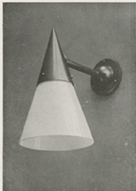
GISO No. 302. Wandlicht. Materiaal: geel koper. Afwerking: bruin brons of mat nikkel. Hoogte 20 cm. Diam. muurplaat 6,6 cm. Diam. glas 12,6 cm.
