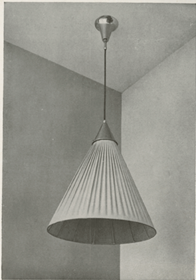
GISO No. 201. Kamerlamp. Materiaal: geel koper. Afwerking: bruin brons of mat nikkel. Kap van Shantungzijde. Kleur: naturel, citroengeel, okergeel of zacht oranje. Diam. kap 45 cm. Hoogte kap 56 cm. Totale hoogte lamp 90 cm. De gloeilamp is aan het oog onttrokken door een open ballon van Giso-glas. Zie onderaanzicht van lamp No. 202.
