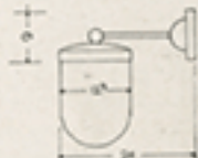
GISO No. 308. Wandlicht. Materiaal: geel koper en Giso-glas. Afwerking: bruin brons of mat nikkel. Voor gloeilampen tot 60 Watt.
