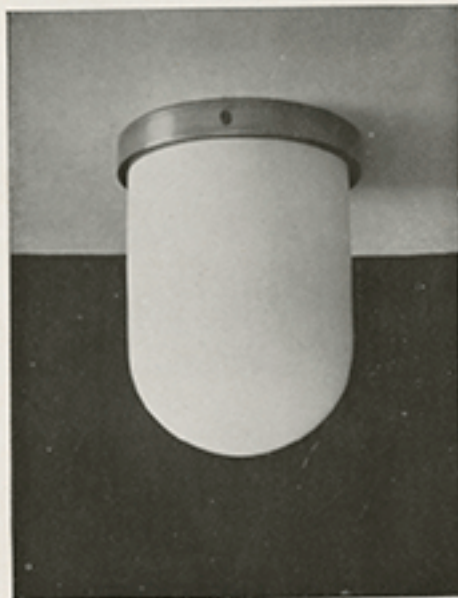
GISO No. 135. Materiaal: geel koper. Afwerking: bruin brons of mat nikkel. Hoogte 18,5 cm. Diam. ballon 12,5 cm. Voor gloeilampen tot 60 Watt.
