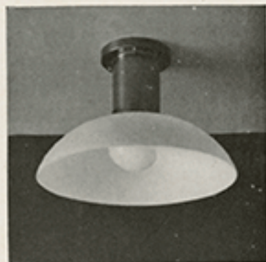
GISO No.123. Kleine plafonnieer. Materiaal: geel koper. Afwerking: bruin brons of mat nikkel. Hoogte 17 cm. Diam. ballon 20 cm. Voor witte opaalgloeilamp van 40—60 Watt.
