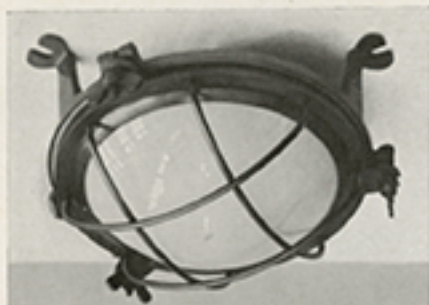
GISO No. 507. Waterdichte plafonnier met beschermingskorf. Materiaal: gegoten brons. Afwerking: zwart brons. Hoogte 12.5 cm. Breedte 23 cm. Diam. glas 18 cm. Voor gloeilampen (Swanfitting) tot 60 Watt.
