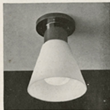
GISO No.125. Kleine plafonnieer voor 40 Watt's gloeilamp v. wit opaalglas. Materiaal: geel koper. Afwerking: bruin brons of mat nikkel. Hoogte 17.5 cm. Diam. metaal 9 cm. Diam. glas 12.5 cm. Voor witte opaalgloeilamp van 40—75 Watt.
