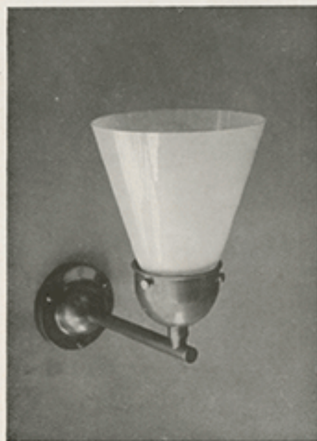
GISO No. 303. Wandlicht. Materiaal: geel koper. Afwerking: bruin brons of mat nikkel. Hoogte 18 cm. Diam. muurplaat 6,6 cm. Diam. glas 12,6 cm. Voor gloeilampen tot 100 Watt.
