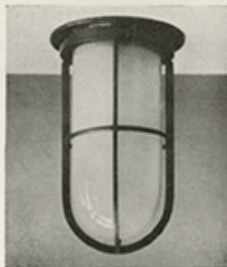
GISO No. 501. Waterdichte plafonnier. Materiaal: gegoten brons. Afwerking: zwart brons. Hoogte 18 cm. Breedte 9 cm. Diam. glas 7,5 cm. Voor gloeilampen tot 40 Watt (Swanfitting).
