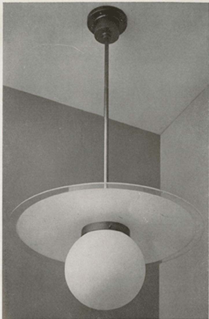
GISO No. 22. Materiaal: geel koper. Afwerking: mat nikkel. Schijf van gematteerd spiegelglas met helderen rand. Diam. 50 cm. Diam. ballon 20 cm. Voor gloeilampen tot 100 Watt. Totale hoogte 90 cm.
