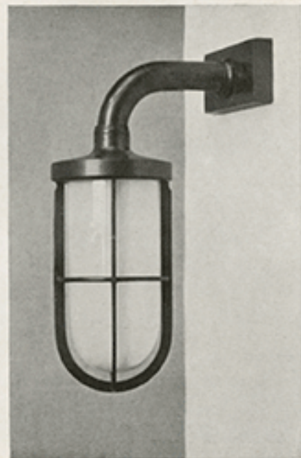
GISO No. 509. Waterdicht armatuur, te gebruiken als plafonnier of als wandlicht. Materiaal: gietijzer, grijs gelakt. Hoogte 12.5 cm., lengte 26 cm., breedte 12 cm. Voor gloeilampen (Swanfitting) tot 60 Watt.
