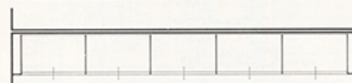
Doorgaande kastwand met eenvoudige rugbeplating, geplaatst tegen bestaande bouwmuur. Diepte 40 of 60 cm.
