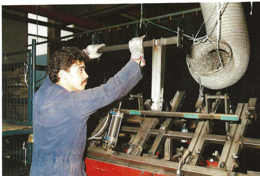
Voor het lassen wordt gebruik gemaakt van een lasmal
