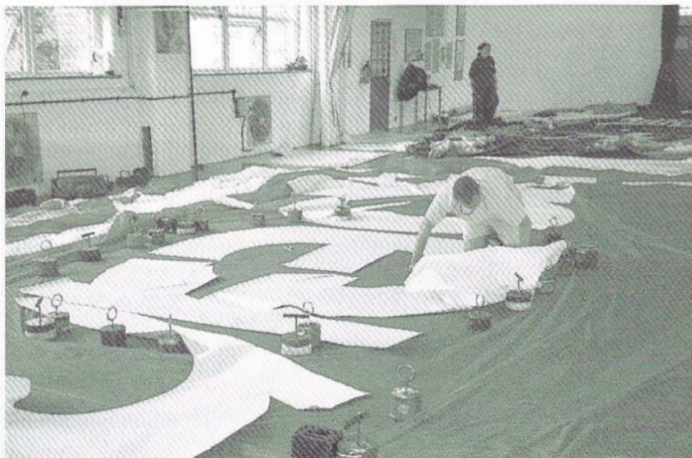
De fabricage van de ballon in de Cameronfabriek te Bristol (GB)
