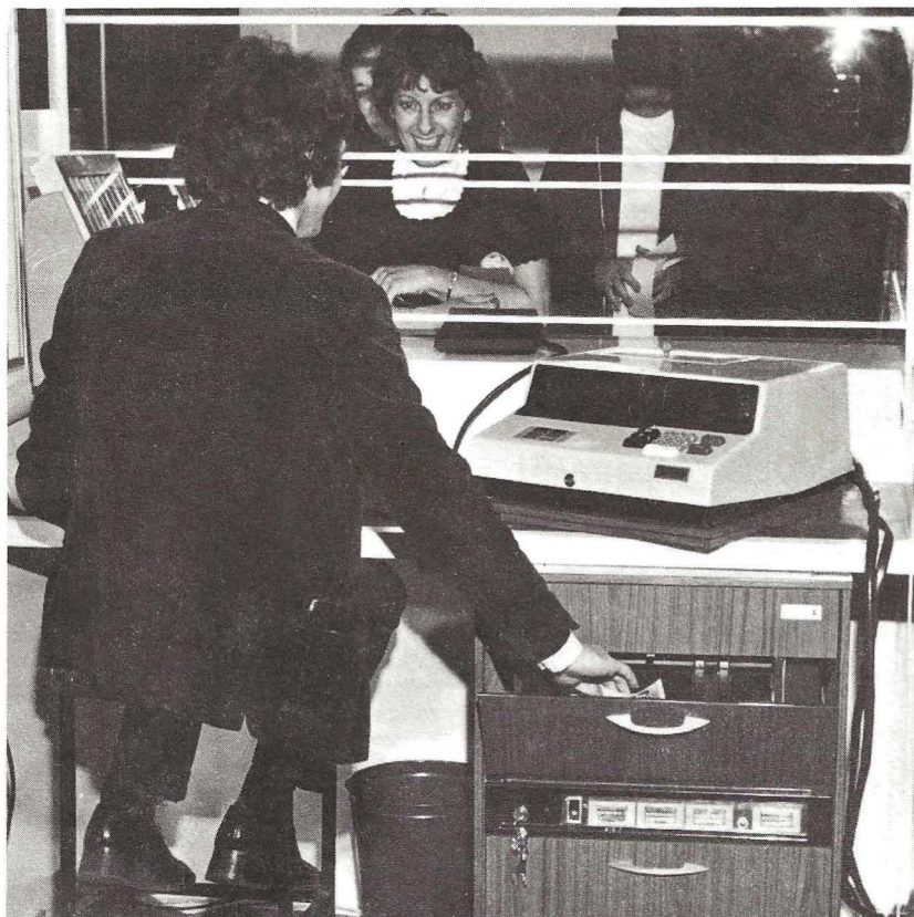
Gelduitbetaalmachine: Een druk op de knop geeft de gevraagde hoeveelheid in bankbiljetten en munten. Alles wordt netjes genoteerd op een band en op het formulier van de klant. De bankbediende hoeft nauwelijks te schrijven en kan daardoor per uur meer klanten helpen.
