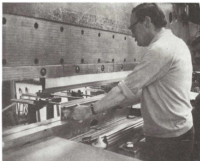
Zoals het was: met de vingers wordt het produkt tegen de aanslagen gehouden.
